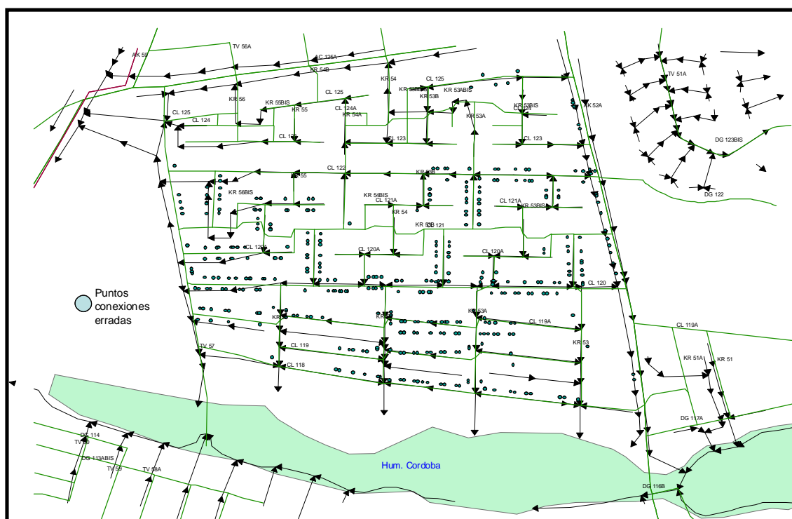
Figura 67. Georeferenciación de las conexiones erradas localizadas en el barrio Niza Sur.
